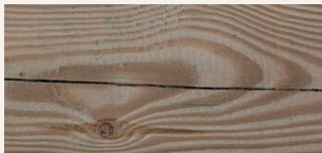
Spannungsrisse durch die Holz Trocknung
