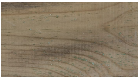
Stockflecken und leichter Schimmelbefall
