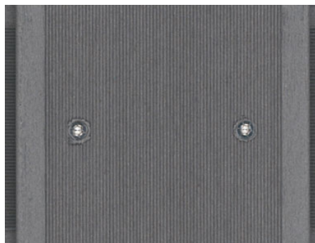
Produktionsrückstände an den Verschraubungen der JUMBO WPC Profile
