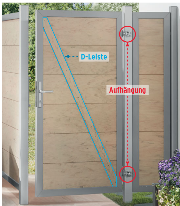
Art. 2443 DESIGN WPC ALU Tor DIN rechts im Farbton Sand. Die Profile der Tore sind in einem umlaufenden Metallrahmen fixiert. Die rückseitige Diagonalverstrebung (D-Leiste) bringt zusätzliche Stabilität. Metalltorpfosten mit angeschweißter Aufhängung (Seite 61).
