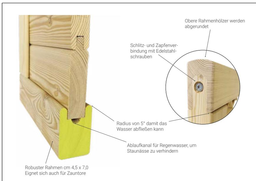
Grundsätzlich setzen wir nur Edelstahlschrauben für den Zusammenbau der Gitter ein. Damit Sie lange Freude an unseren Gittern haben, werden die Nägel nicht "geschossen" sondern jede Schraube einzeln verschraubt.
